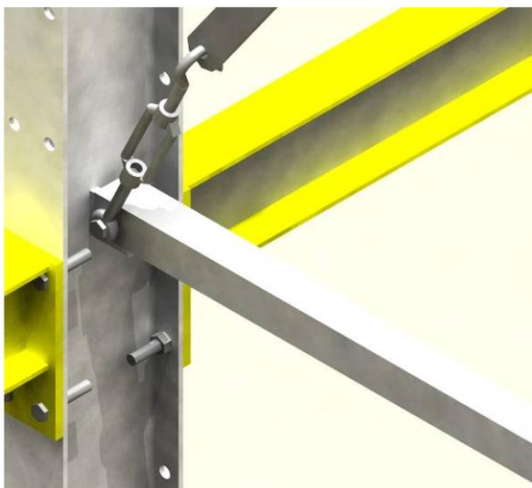
Натяжение талрепа осуществляется специальным натяжителем (см. рис.4). Натяжители затягиваются попарно, чем достигается выравнивание стеллажа в основной плоскости стеллажа. Затяжка натяжителей должна быть регулируемой, сила затяжки 12000-13000Н.
